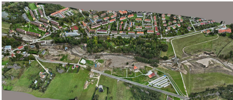
Rys. 1. Model mesh zapory w Stroniu Śląskim po katastrofie wraz z dokumentacją zniszczeń w dolinie poniżej – uszkodzenia infrastruktury i zabudowy, rozmycia terenu i zmiany w korycie (fotogrametria BSP)
