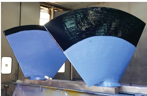
Fot. 2. Łopata turbiny wodnej z powłoką hydrofobową Belzona®1341 oraz zabezpieczeniem przeciwkawitacyjnym Belzona®2141
