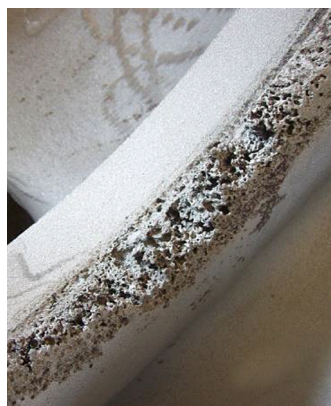
Fot. 1. Wżery kawitacyjne w warstwie wierzchniej korpusu pompy
