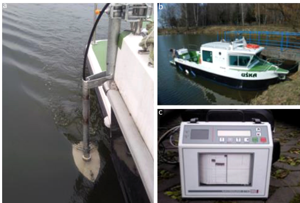
Fot. 1. Aparatura do pomiarów batymetrycznych: a) głowica echosondy przy burcie łodzi, b) łódź – kuter pomiarowy, c) jednostka formatująca echosondy. Zestaw wykorzystywany do pomiarów na zbiorniku Goczałkowice w 2014 roku
