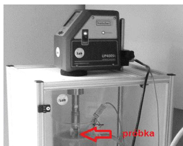
Rys. 2. Stanowisko do badań materiałów w kawitacji wywołanej ultradźwiękami
