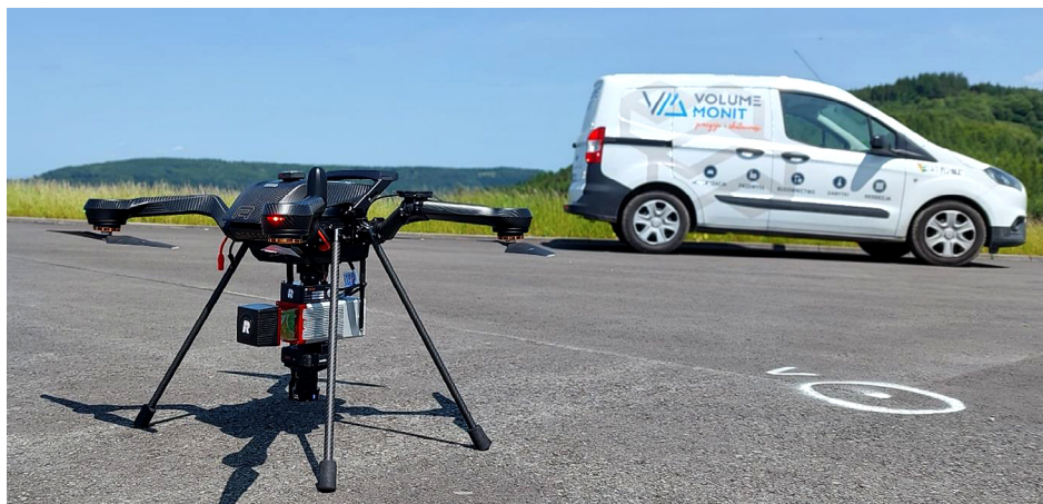
Fot. 1. Dron Acecore Zoe wyposażony w LiDAR Riegl miniVUX-3 oraz aparat pełnoklatkowy przed startem na obwałowaniu zbiornika górnego Elektrowni Szczytowo-Pompowej Porąbka-Żar
